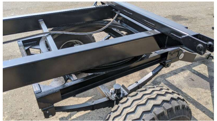
Sistema de quinta rueda de gran capacidad, con 1 mt de diámetro que permite soportar las tareas más difíciles. Trocha, llantas y muelles dimensionados de alta capacidad.
