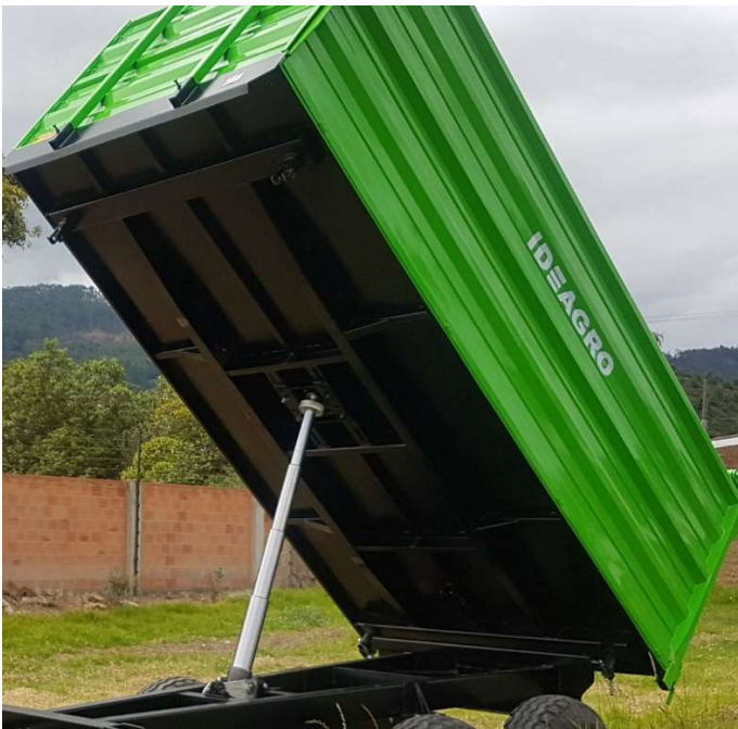
Cilindro hidráulico telescópico de alta capacidad con terminación de rotula.
