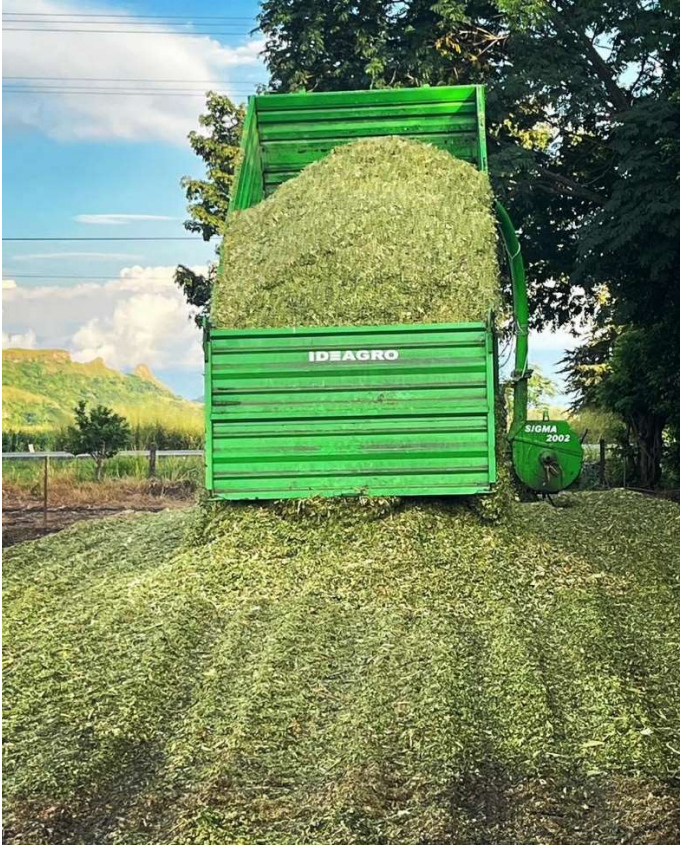
Sistema Trapezoidal que facilita su descarga
